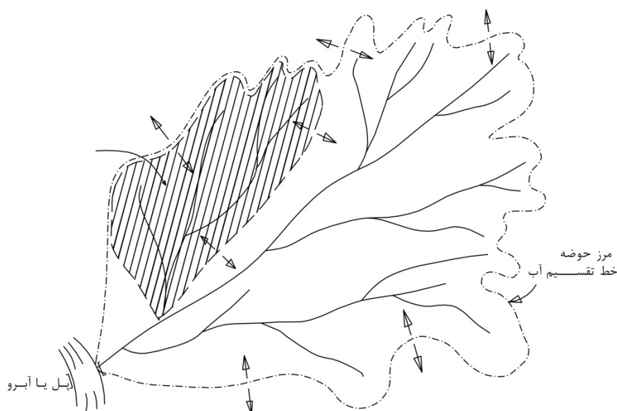
شکل ۱۰-۱- تشکیل دبی سیلاب (رواناب سطحی) در یک حوزه آبریز بزرگ
